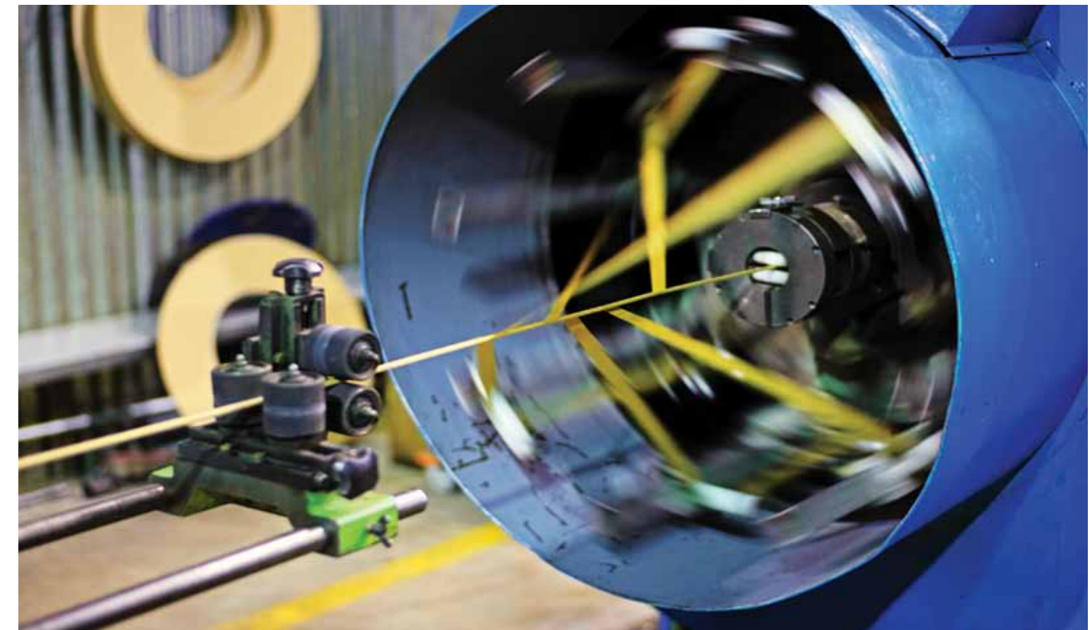
Производство проводов с бумажной изоляцией
