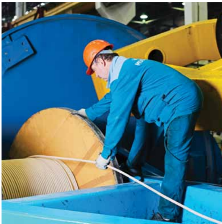
Операция общей скрутки кабелей с полимерной изоляцией
