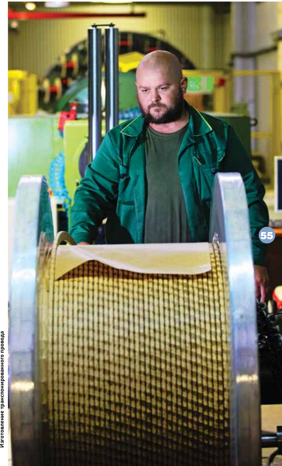
Изготовление трансформированного провода
