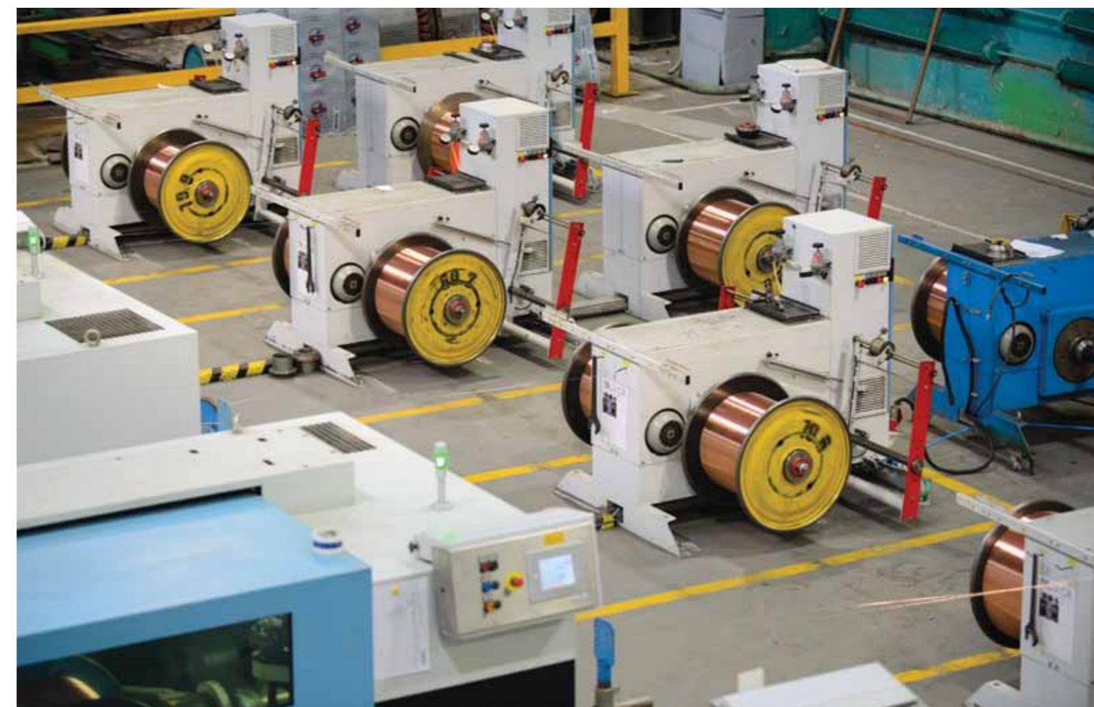
Современная линия многониточного волочения и скрутки для производства медной ТПЖ
