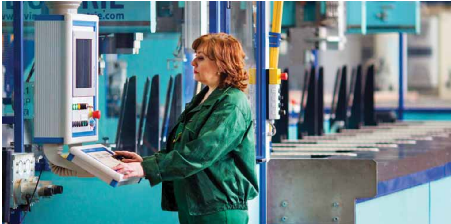
Автоматизированная линия по производству обмоток для электрических машин
