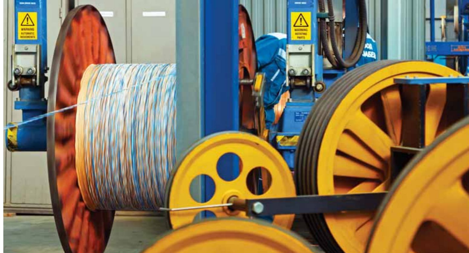
Сердечник из скрученных изолированных жил
