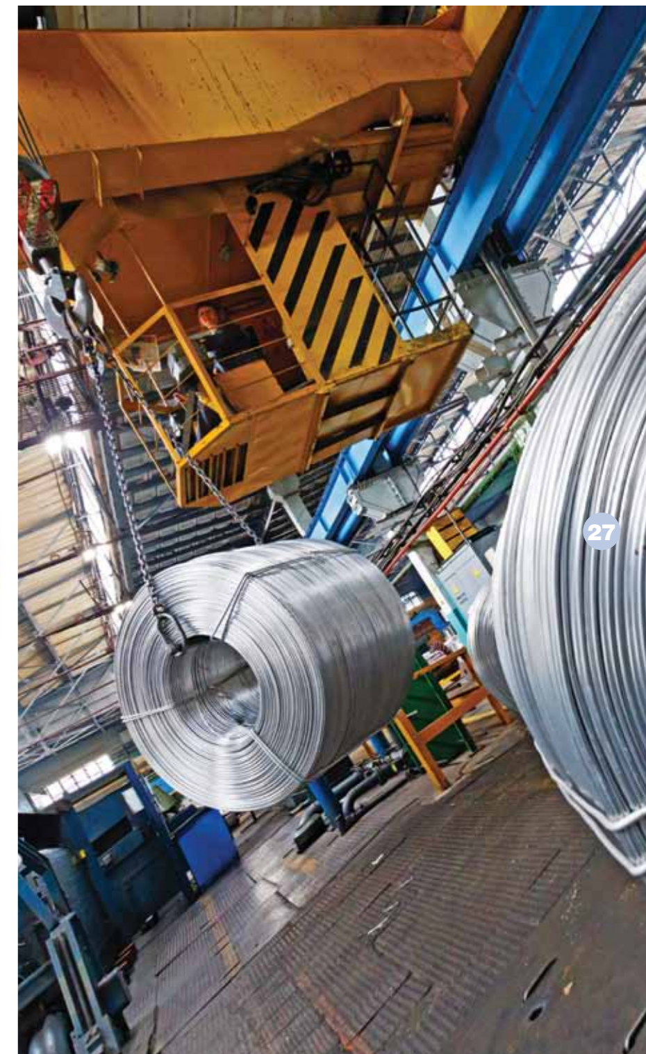
Транспортировка бухты с алюминиевой катанкой
