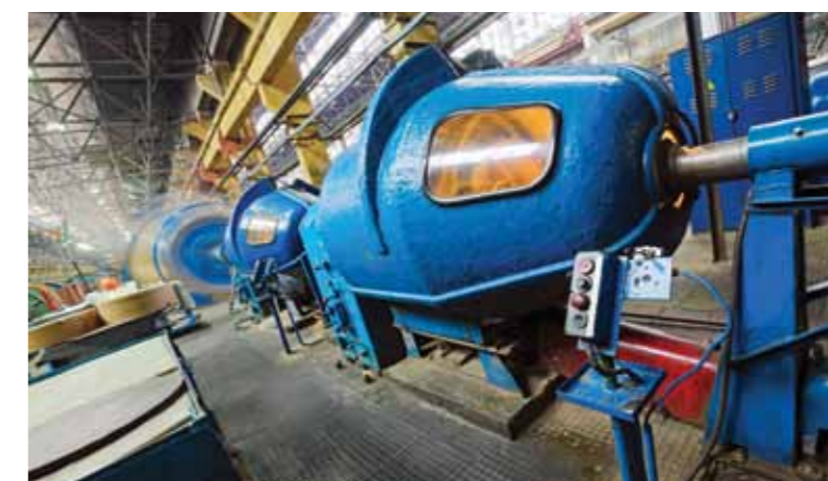
Процесс наложения изоляции на кабели с БПИ
