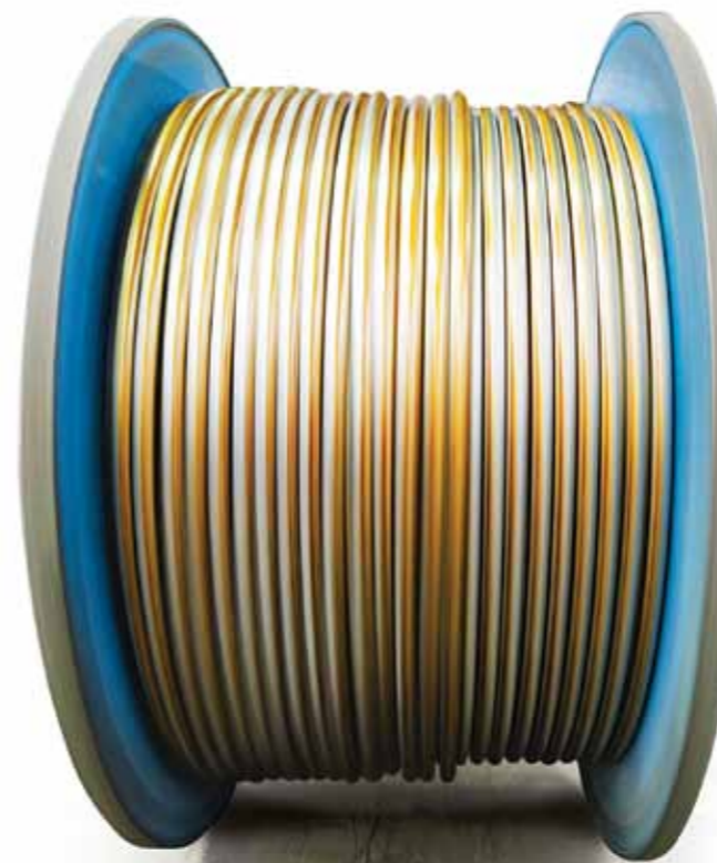
Кабель с ВПИ после технологической операции наложения свинцовой оболочки
