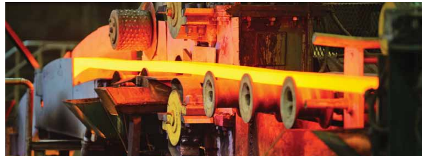
Производство медной катанки на установке Southwire
