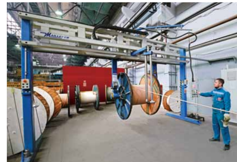
Процесс наложения внутренней оболочки на кабели с полимерной изоляцией
