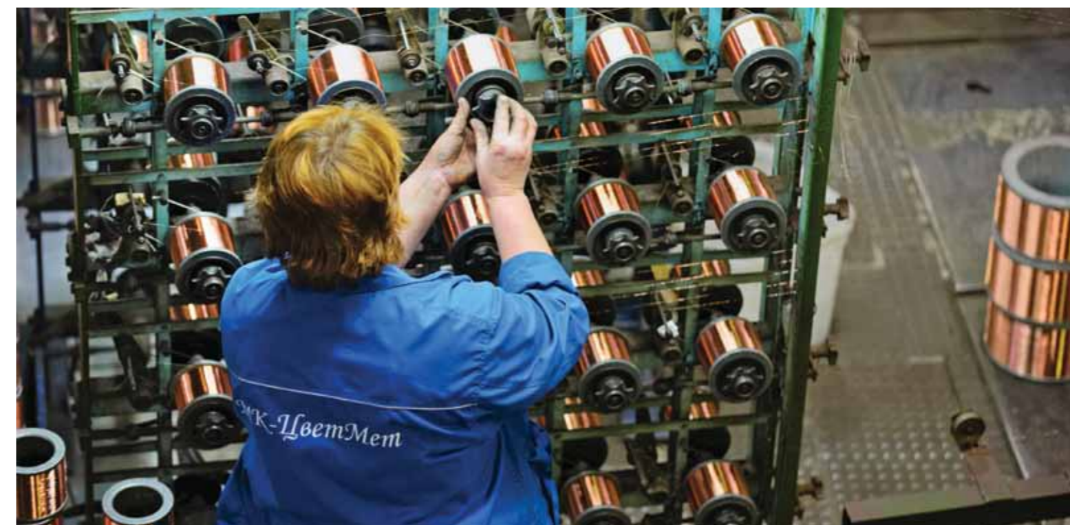
Установка отдающих катушек с проволокой в процессе производства проводов для щеток электрических машин марки ПЩ
