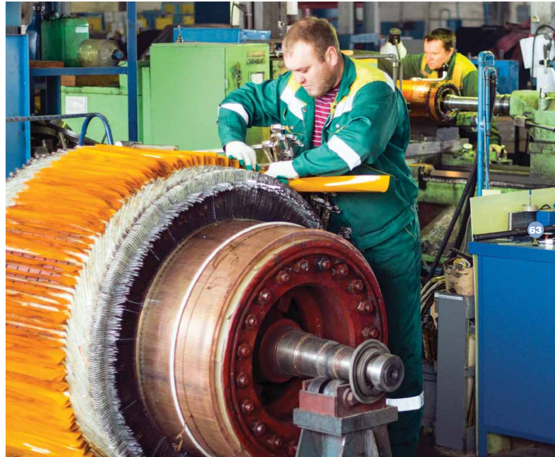
Процесс укладки обмотки якоря
